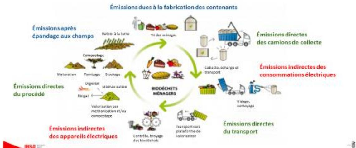
Figure 14 : les principaux postes d'émission de GES lors du traitement de biodéchets
